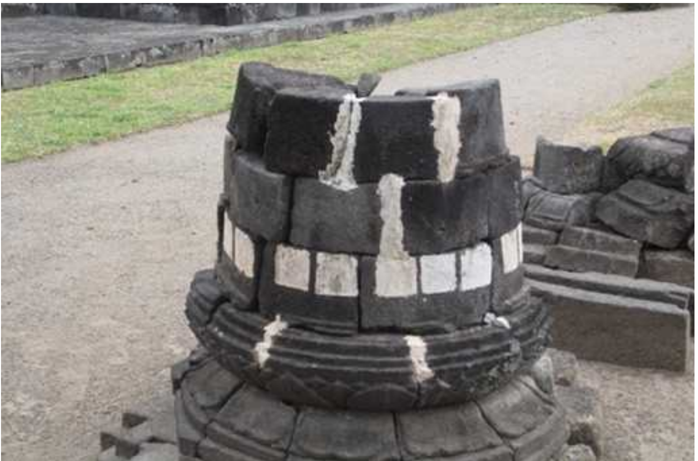
Uji coba vajralepa dari sisi komposisi material dan warna (Foto koleksi Wahyu Indrasana)
