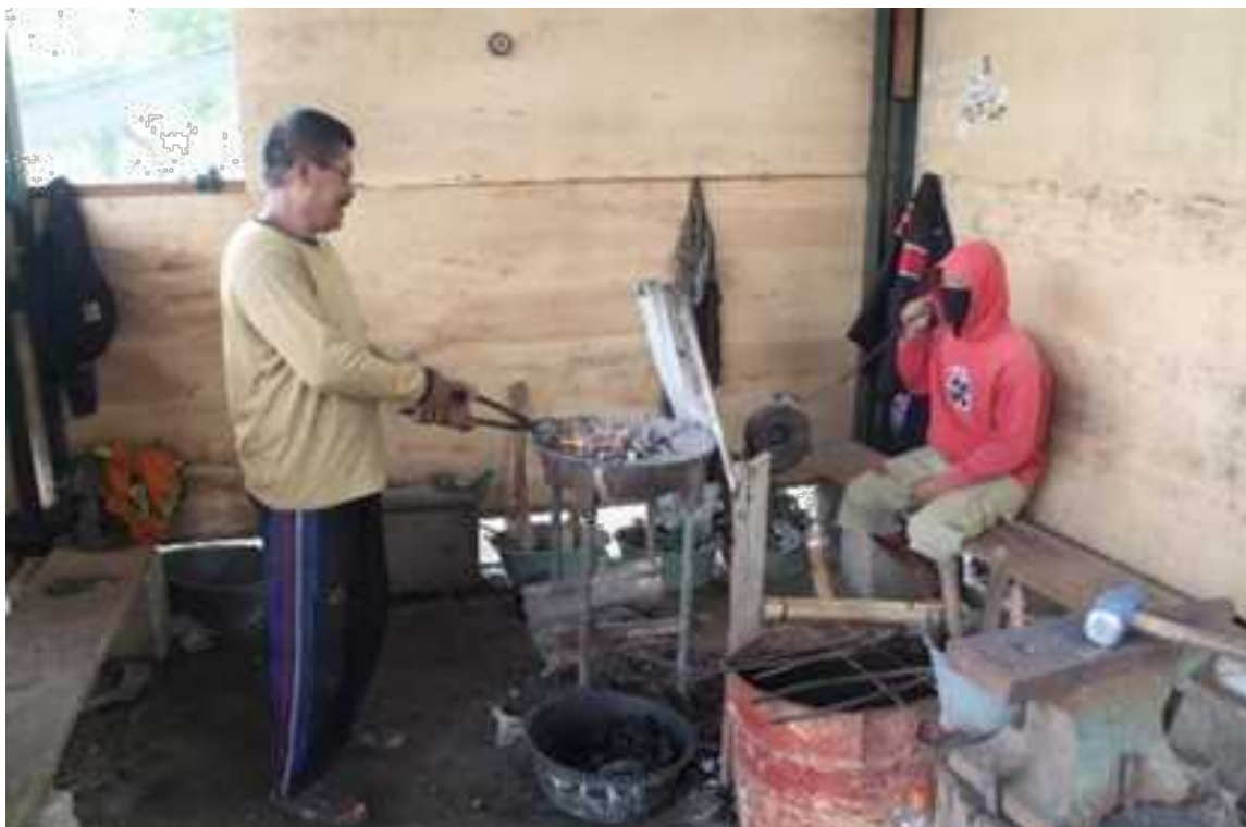
Pemanasan plat besi untuk membuat tatah batu (Foto koleksi Wahyu Indrasana)
