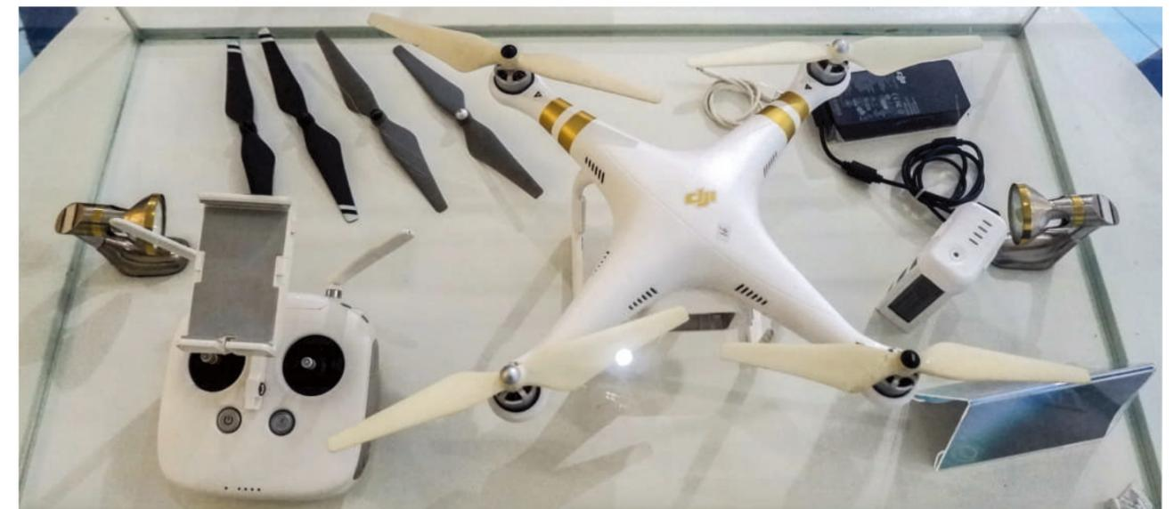
Drone Koleksi Museum Gumuk Pasir merk DJI Phantom 3 tipe Quadcopter dengan jangkauan 1x baterai, 30 Hektar dengan ketinggian 80 meter s/d 150 meter. Dibuat tahun 2015 dan berfungsi sebagai Wahana Pemotretan Udara/Akuisisi Data Penginderaan Jauh. (Foto: Dokumentasi Museum Gumuk Pasir)
