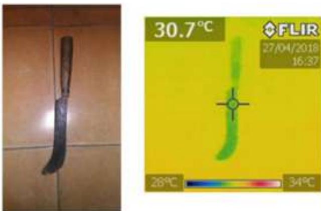
Gambar 3. Hasil Infrared Camera FLIR pada Sabit (Arit)
